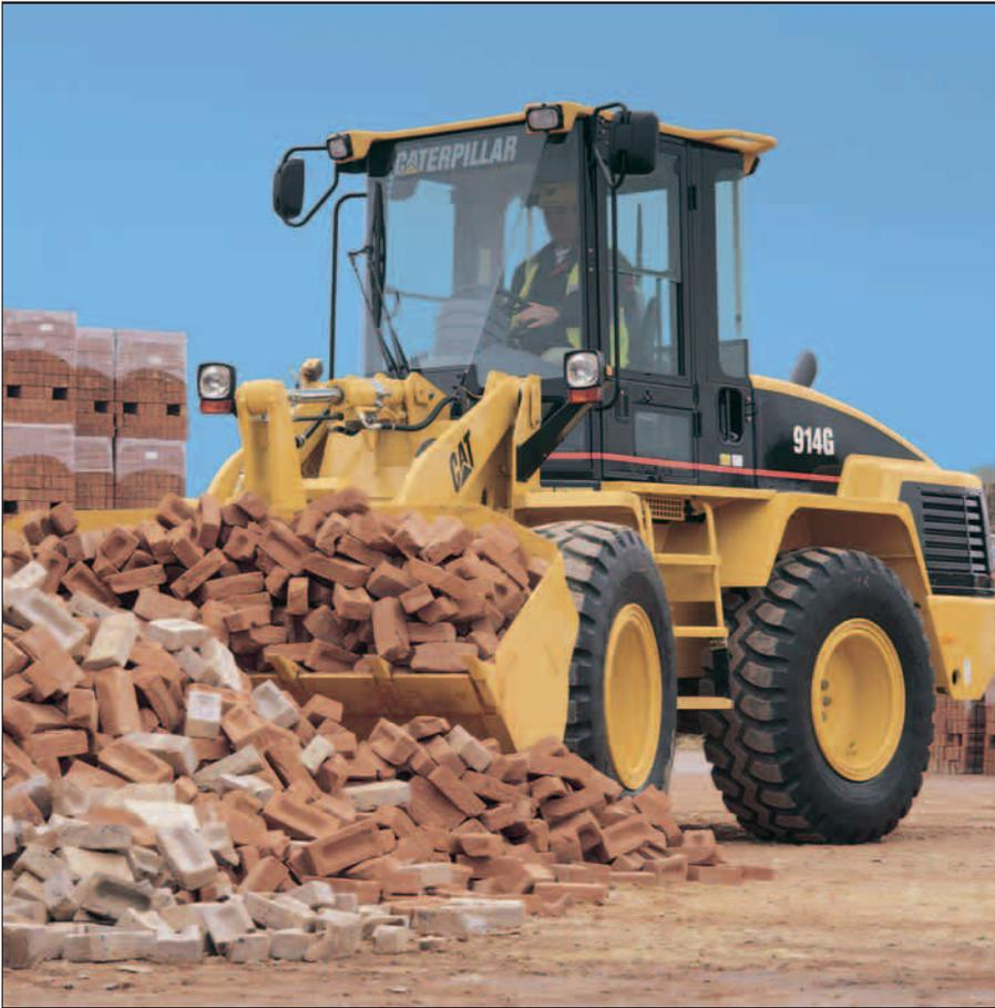
**Dieselmotor 3054C T.** Im 914G und IT14G entwickelt der Cat Vierzylindermotor mit Abgasturboaufladung eine Nennleistung (ISO 9249) von 72 kW (98 PS), die beiden Maschinen in unterschiedlichsten Einsätzen zu hoher Produktivität verhilft.
