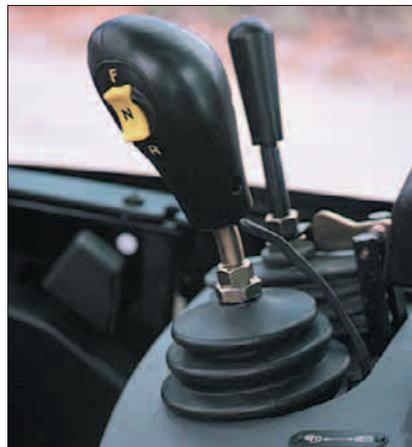
**Hydrauliksteuerung.** Dank der hydraulischen Vorsteuerung lässt sich der Kreuzsteuerhebel für die Hub- und Kippfunktionen besonders leicht und feinfühlig betätigen. Der in den Hebelknopf integrierte Fahrtrichtungsumschalter bringt eine weitere Bedienungserleichterung mit sich. Zur Steuerung von hydraulischen Anbaugeräten sind zwei weitere Steuerhebel installierbar. Die Reaktion der hydrostatischen Lenkung passt sich automatisch an die Drehgeschwindigkeit des Lenkrads an.
