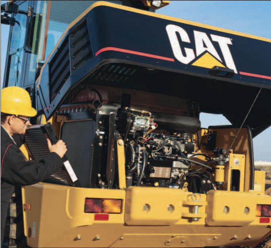
**Zugang.** Nach dem Hochschwenken der einteiligen, gasfederunterstützten Motorhaube sind Filter und Wartungsstellen frei zugänglich. Reinigungsarbeiten an Wasser- und Hydraulikölkühler können mühelos erledigt werden.
