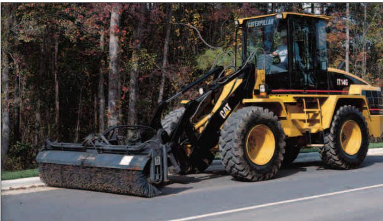
**Materialumschlag.** Das Haupteinsatzgebiet des Industrie-Radladers IT14G liegt im Materialumschlag, den die Maschine besonders effizient bewältigt. Spezielle Arbeitsgeräte erlauben eine einsetzgerechte Ausrüstung:
